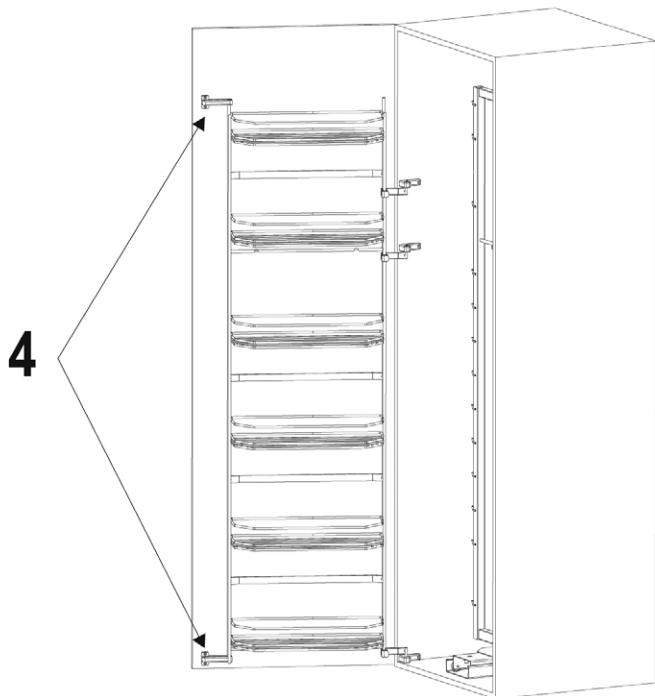
**4** Otevřete regál dveří až na doraz, nahoře a dole nasad'te na regál dveří unášeč, určete polohu podle závěsu dveří a přišroubujte jej.
