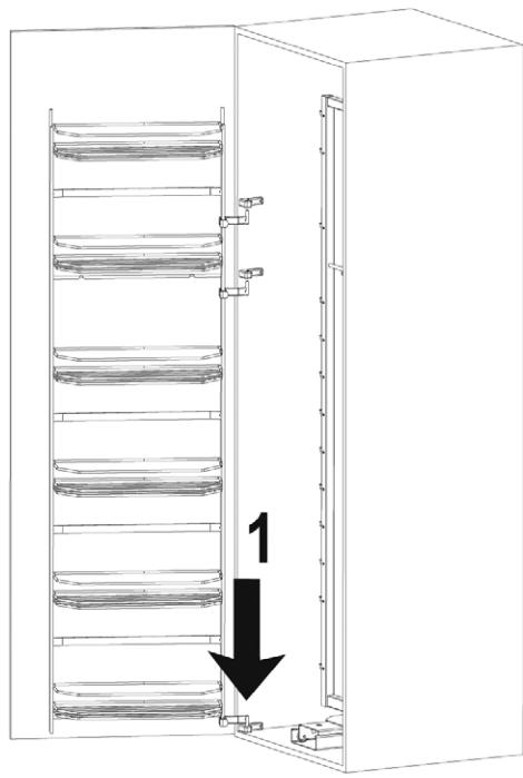
**1** Regál dveří nasad'te do spodního ložiska
