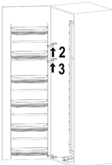
**2+3** Povolte horní a střední připojení dveří, nasuňte je a přišroubujte
